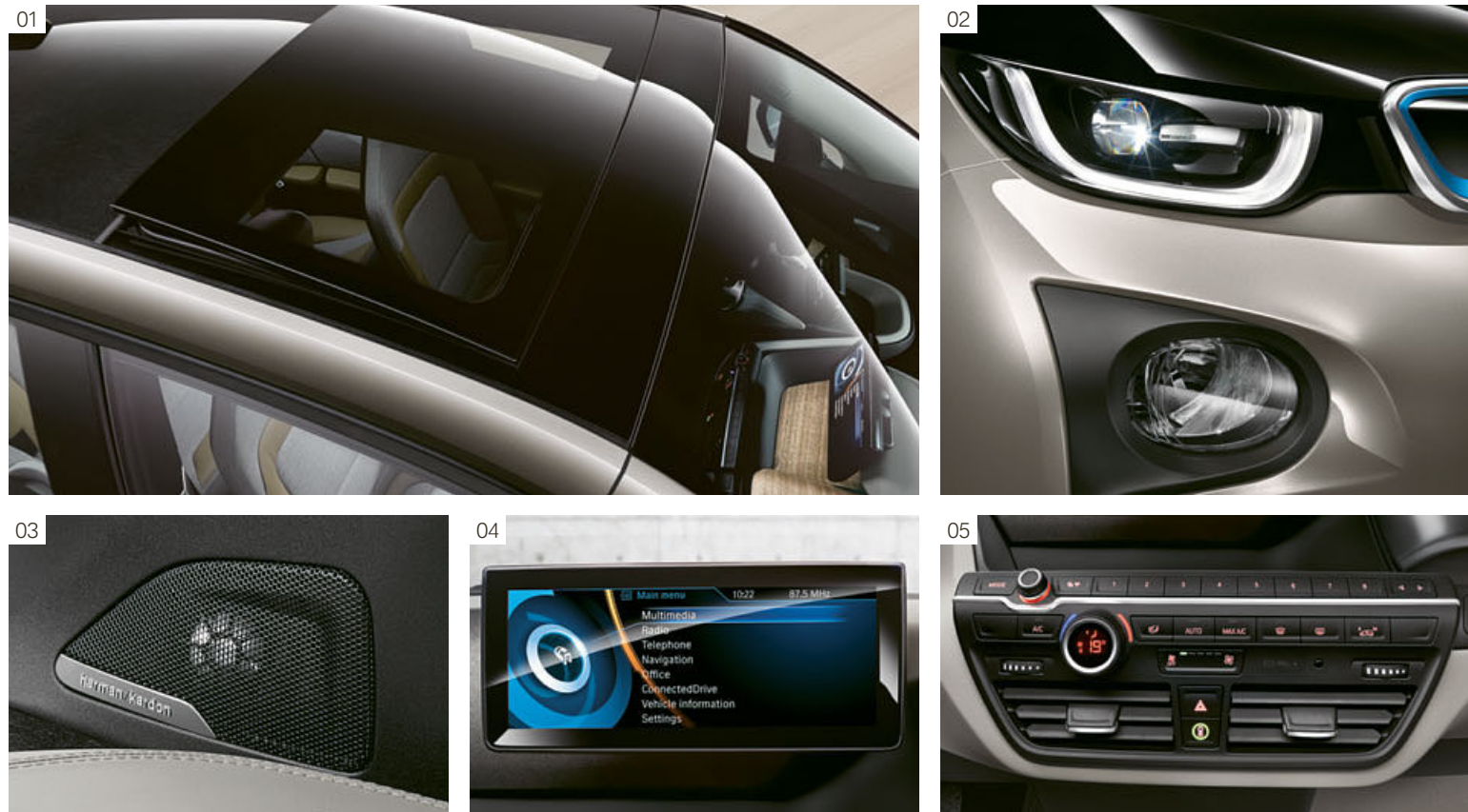
[ 01 ] Toit ouvrant en verre coulissant et entrebâillable électriquement (option) , avec vitrage calorifuge, protection anti-pincement et ouverture / fermeture confort via la télécommande ou une commande par impulsion, pour une atmosphère agréable dans l'habitacle. [ 02 ] Projecteurs LED (option) , assurant un éclairage optimal de la chaussée. [ 03 ] Système Hi-Fi Harman Kardon (option) . Un amplificateur numérique sept canaux de 360 W et 12 haut-parleurs parfaitement équilibrés assurent une expérience acoustique au plus haut niveau. [ 04 ] Navigation multimédia Professional (option) , y compris « Controller » iDrive Touch avec pavé tactile et écran couleur fixe 10,2" (25,9 cm) avec capacité de stockage de 20 Go pour fichiers audio. [ 05 ] Climatisation automatique (option) , avec régulation automatique de la température et du débit d'air.
